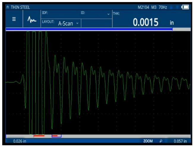
72DL PLUS厚さ計をM2104 (125 MHz) 探触子とともに使用して、薄い鋼板 (0.0015インチ、0.0381 mm) を測定
